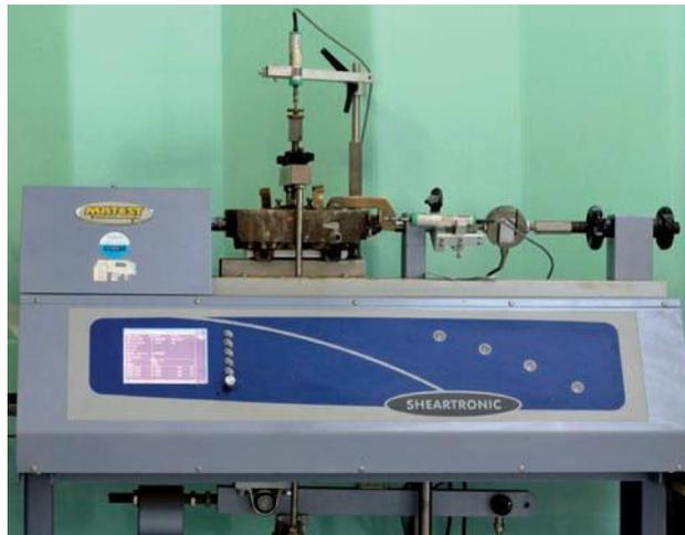
Dal TD in condizione Consolidata Non Drenata (CU) non è possibile ottenere una parametrizzazione utilizzabile in quanto la scatola di Casagrande non permette alcuna misurazione delle pressioni neutre, mentre la Non Consolidata Non Drenata (UU) è una condizione che non si realizza neanche impostando velocità di deformazione elevatissime.
