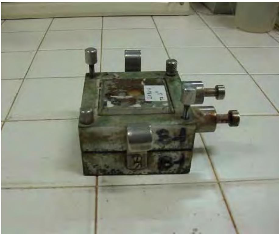
Fig. 1 - Scatola di Casagrande. Il provino è posto all'interno (foto: Geoplanning S.r.l.).
