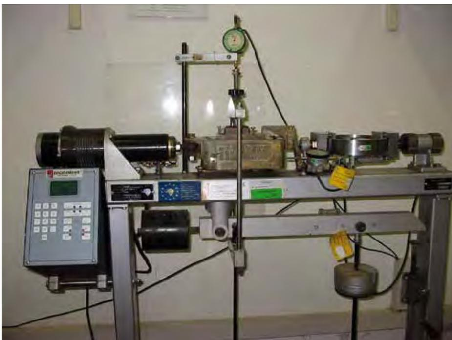
Fig. 3 - Apparecchiatura per la prova TD. La scatola è inserita in un alloggiamento pieno d'acqua e solidale con il motore: la semiscatola superiore è collegata all'anello dinamometrico. Il ponticello applica la pressione normale e permette la misura delle deformazioni verticali. Il comparatore sul lato esterno, solidale col movimento del motore, misura le deformazioni orizzontali (foto: Geoplanning S.r.l.).
