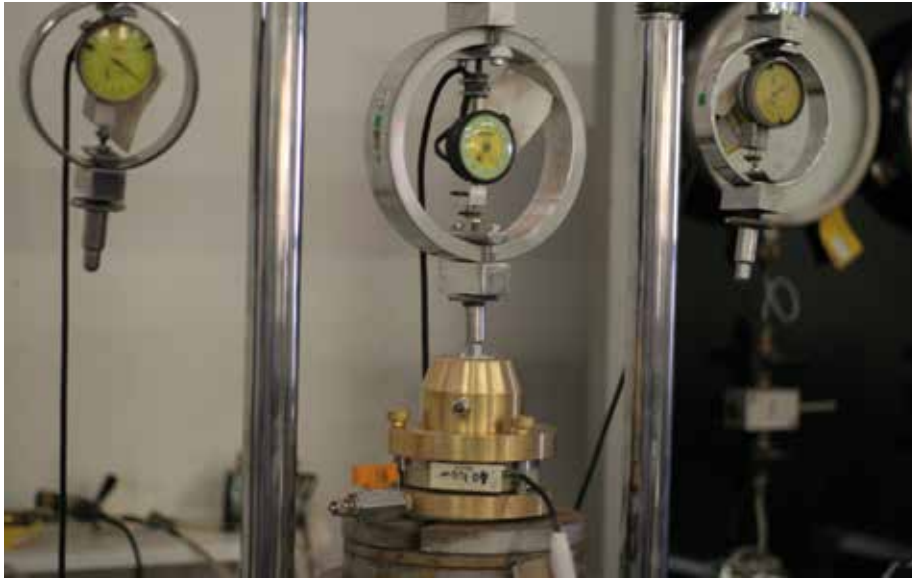
Fig 6 - Prova K_0 eseguita con pressa per triassiali: la cella è composta da ottone pesante e da acciaio (anello e supporti).
