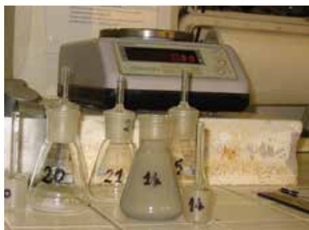
Fig. 1 - Picnometri in diversi stadi della determinazione del peso di volume dei grani.
