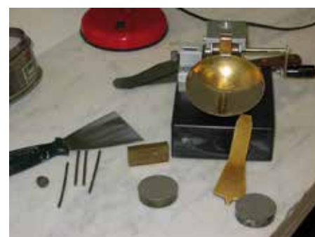
Fig. 3 - Attrezzature per la determinazione dei Limiti di Atterberg. A sinistra: cilindri di terreno per il LP con le bacchette di riferimento e prisma di ottone per la calibrazione della coppella di Casagrande. A destra in primo piano le capsule contenenti il materiale da sottoporre a determinazione del LR; in secondo piano coppella di Casagrande per la determinazione del LL e ferro solcatore.
