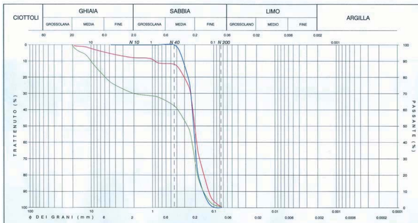
Figura 6 – Curve granulometriche delle sabbie analizzate: blu (autoctona), verde (alloctona di arenile) e rossa (alloctona di battigia).
