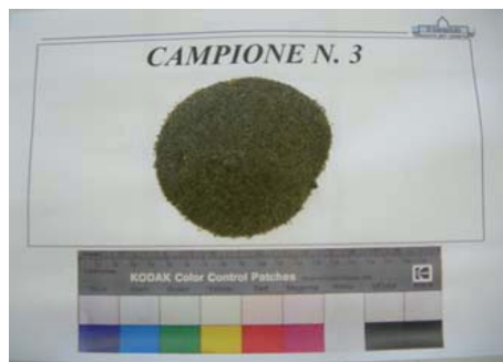
Figure 9a-b-c – Sabbia “alloctona” di battigia. Documentazione fotografica macroscopica (a) e microscopica in sezione sottile (b-c rispettivamente Nicols paralleli ed incrociati).
