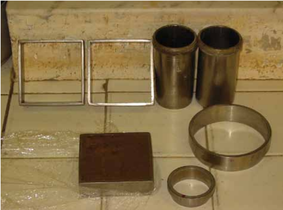
Fig. 5 - Esempi di fustelle per la determinazione del peso di volume naturale e per il confezionamento di provini per prove meccaniche (foto: Geoplanning Servizi per il Territorio S.r.l.).
