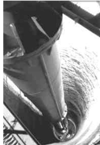
*fig. 18 Dettaglio: prova di carico su piastra in pozzo*
