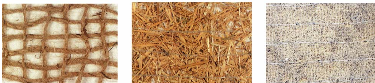
Fig. 16 – Esempi di materiali di rivestimento biodegradabili: a sinistra georete in fibra di juta, al centro biostuoia in paglia ricoperta con materiale plastico fotodegradabile, a destra biostuoia in fibra di cocco ricoperta con materiale plastico fotodegradabile (da REGIONE LIGURIA, 1997) -
