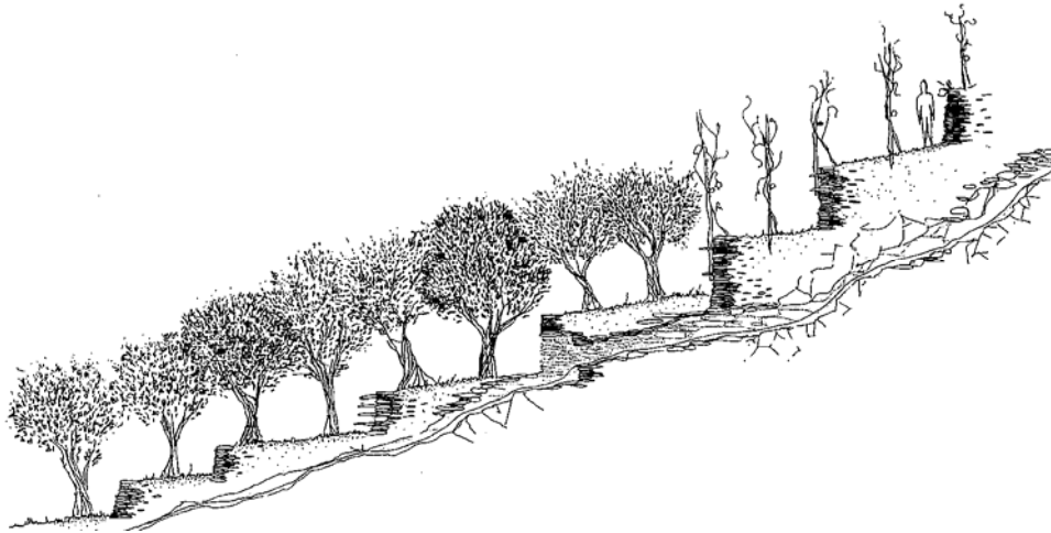
Fig. 64 – Esempio schematico di utilizzo di muretti a secco nella stabilizzazione della coltre detritica di un versante tramite gradonatura (da BRANCUCCI et al., 2000) -
