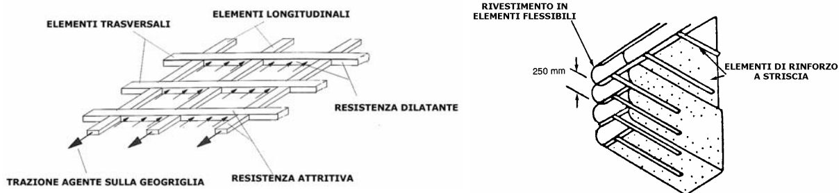
Fig. 106 – Rinforzi a griglia a sinistra e a striscia a destra. Nel caso di rinforzi a striscia, il trasferimento degli sforzi dal terreno avviene per attrito lungo l'interfaccia suolo-rinforzo; per rinforzi a griglia, oltre all'attrito lungo gli elementi longitudinali, viene mobilitata al momento dello scorrimento la resistenza dilatante del terreno che si inserisce nelle aperture -
