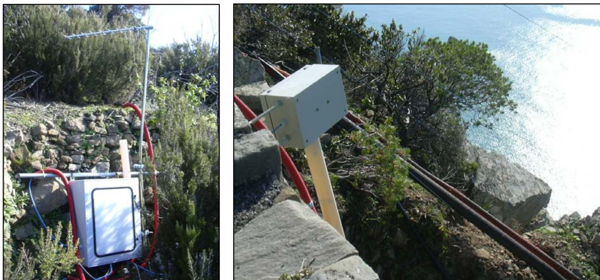
Fig. 137 –Sistema di monitoraggio-allerta installato per il controllo dei fenomeni di instabilità sui ripidi versanti del promontorio di Monesteroli (SP), nel Parco Nazionale delle Cinque Terre. Il sistema di monitoraggio-allarme è costituito da fessurimetri per il controllo delle lesioni su alcuni edifici e da deformometri rotativi a filo per il monitoraggio di alcuni blocchi di roccia disancorati dal substrato che minacciano l'abitato; i dati acquisiti a intervalli di tempo regolari vengono trasmessi tramite il sistema GSM (nello specifico alla Provincia di La Spezia e al Dipartimento di Scienze della Terra di Firenze), il sistema è in grado inoltre di inviare segnali di allarme (alle autorità competenti) nel caso di superamento di soglie di spostamento prefissate. Sulla destra uno dei deformometri installati, sulla sinistra la centralina di acquisizione-trasmissione dati -
