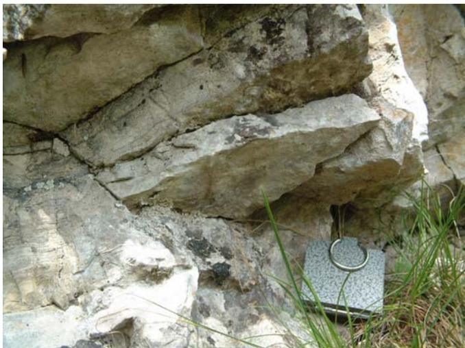
*Figura 3: esempio di spaziatura tra due discontinuità*
