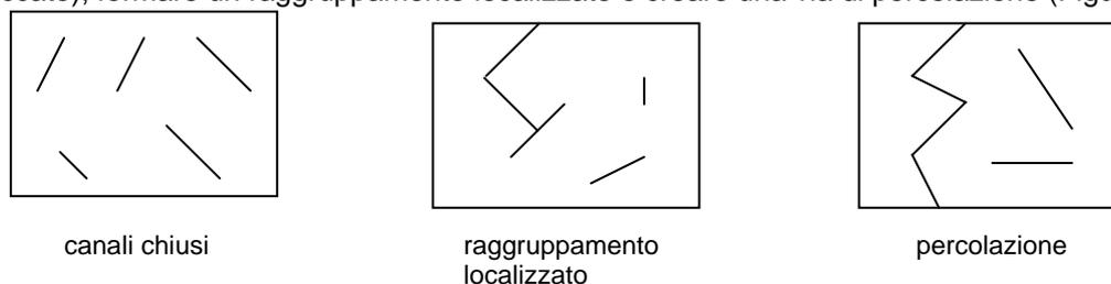
Figura 16: esempi di reti di percolazione
