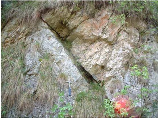
Figura 4: esempio di apertura delle discontinuità
